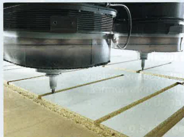
Double broche de défonceuse et unité de perçage.
