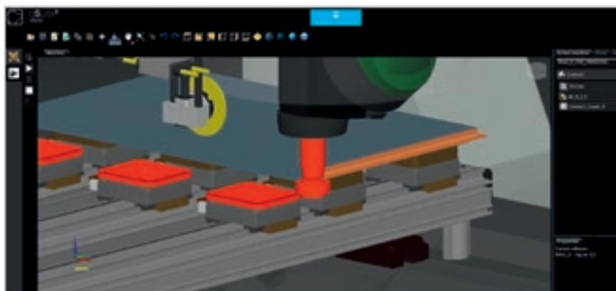
Благодаря системе контроля можно следить непосредственно из офиса за возможными столкновениями между деталями станка, с функцией предупреждения и корректировки имеющихся ошибок.
