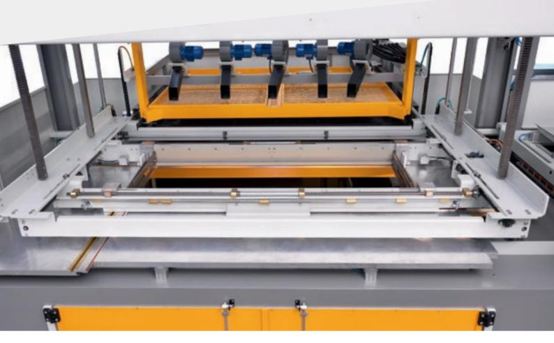
Le serre-flan avec réglage automatique bloque parfaitement la plaque à façonner pour une finition parfaite. Ventilateurs pour refroidir la pièce lors du finissage.
