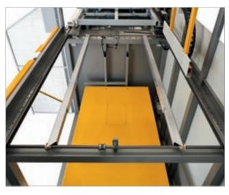
Le dispositif de centrale permet de régler automatiquement la position correcte de la plaque
