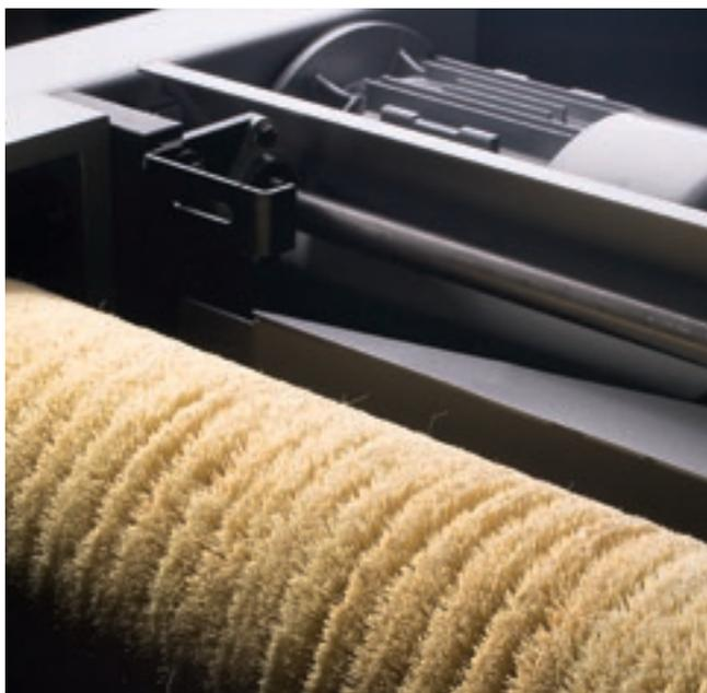
A **escova de limpeza do painel** pode ser equipada com cerdas de materiais diferentes para realizar uma limpeza profunda dos painéis mecanizados.
