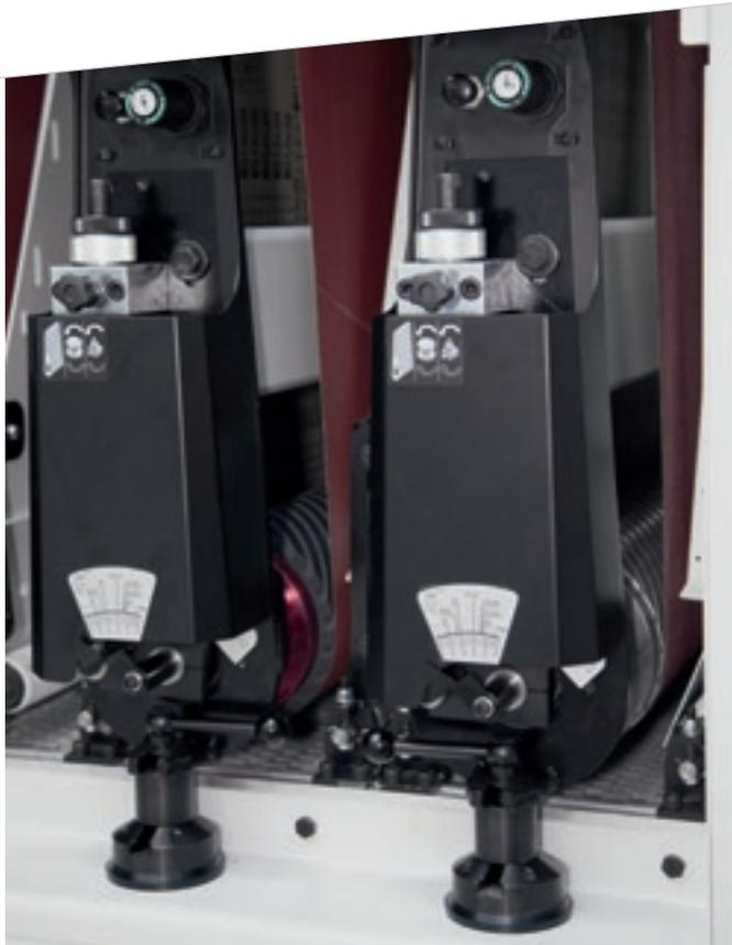
O **grupo Rolo** é extremamente preciso e eficaz. De acordo com a dureza da borracha utilizada e o diâmetro do próprio rolo, o grupo pode ser usado para calibrar, lixar ou polir.
