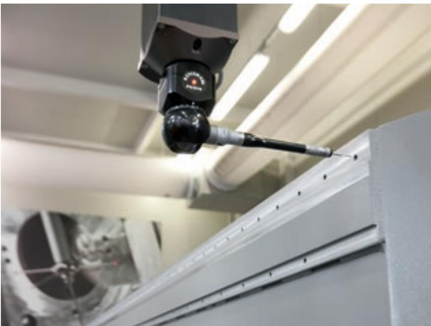
Todas las bases respetan la tolerancia de 2 centésimas de milímetro por metro lineal. De esta forma, además de garantizar la calidad de las puertas y ventanas, se evitan las operaciones de rectificación en fase de montaje, que inevitablemente retrasarían la entrega de la máquina.
