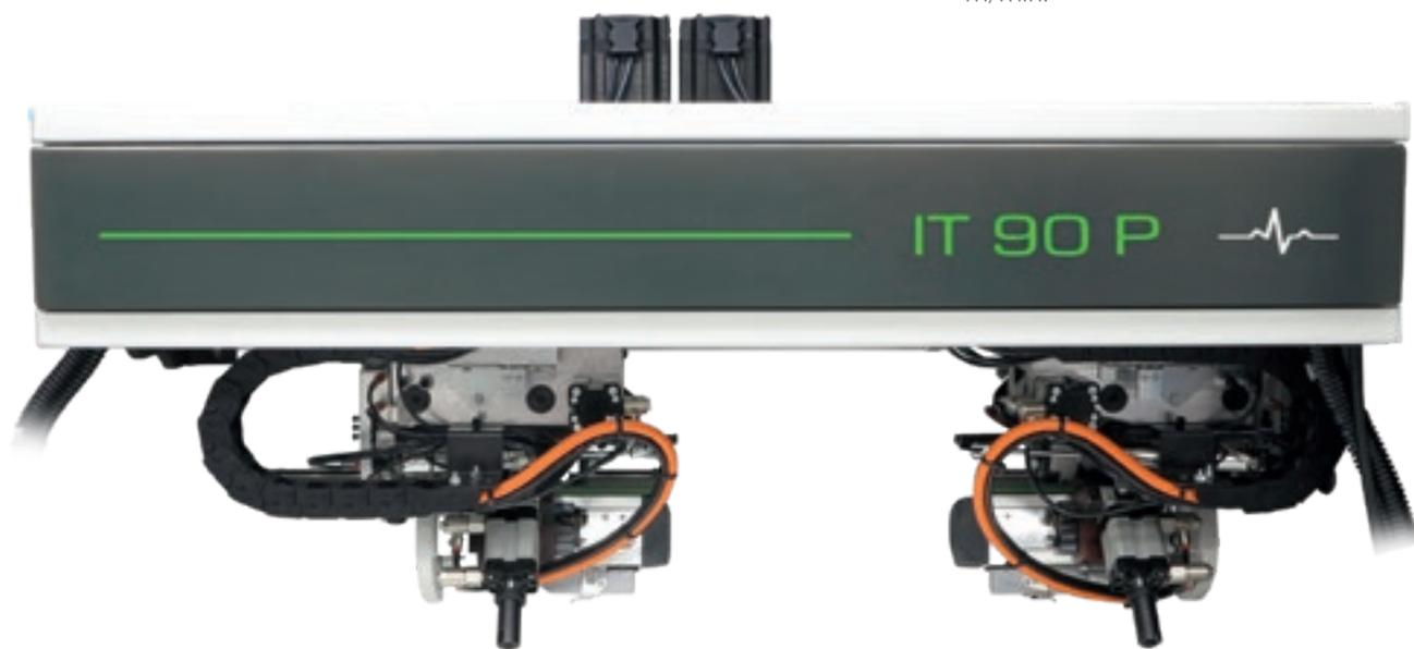
CALIDAD Y PRECISIÓN DE CORTE GRACIAS AL GRUPO RETESTADOR QUE PERMITE ELIMINAR LA PARTE SOBRENTE DEL CANTO EN LA CABEZA Y EN LA COLA DEL PANEL. DIVERSAS SOLUCIONES DISPONIBLES EN FUNCIÓN DE LAS NECESIDADES DE MECANIZADO.
