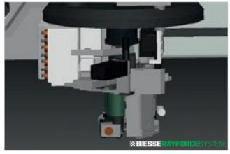
模拟加工和多种封边装置 (普通胶水封边或RayForce System)。
